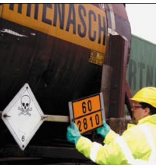
Für den Notfall: Korrekte Gefahrguttafeln.
